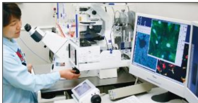
各種素材の生理機能発現メカニズムに関する研究(共焦点レーザー顕微鏡)
