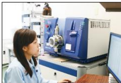
微量の農薬も検出可能な分析機器での残留農薬の一斉検査 (LC/MS/MS)
