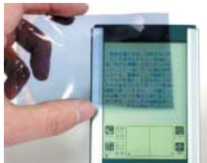
酵素合成アミロースから得られる偏光フィルム 偏光フィルムをあらかじめ取り除いた電子手帳に、 酵素合成アミロースから作成した偏光フィルムを重ねたもの。)
