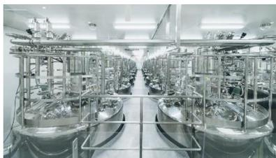
タンクでアイスクリームミックスの材料を混ぜ合わせ、均質化・殺菌した後、「エージングタンク」と呼ばれる巨大なタンクで温度を4℃まで下げて熟成させます。
