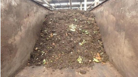
発酵槽はボウリングのレーンのように細長い。1本の幅は 3 メートル、長さは 50 メートル。およそ 1 対 1.5 の割合で混合した食品廃棄物と木質チップを、レーンの手前側に投入する。レーンの上部にある攪拌機がレーンに沿って動き、有機物を混ぜ合わせて奥に向かって 1 日 2 メートルずつ送り込んでいく。約 1 か月経つと、発酵槽を通過
